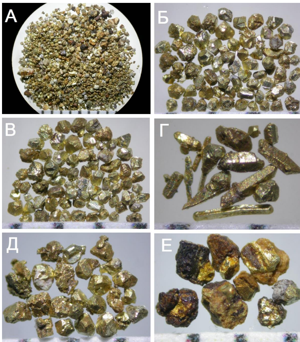
Рисунок 3.5.1 – Характер шлиха (А), изометричные простые и сложные кристаллы электрума (Б, В), искаженные формы электрума (Г), сростки электрума с жильным и вторичными минералами (Д, Е). Фото сделаны под стереомикроскопом (см. линейку по нижнему краю фото).
