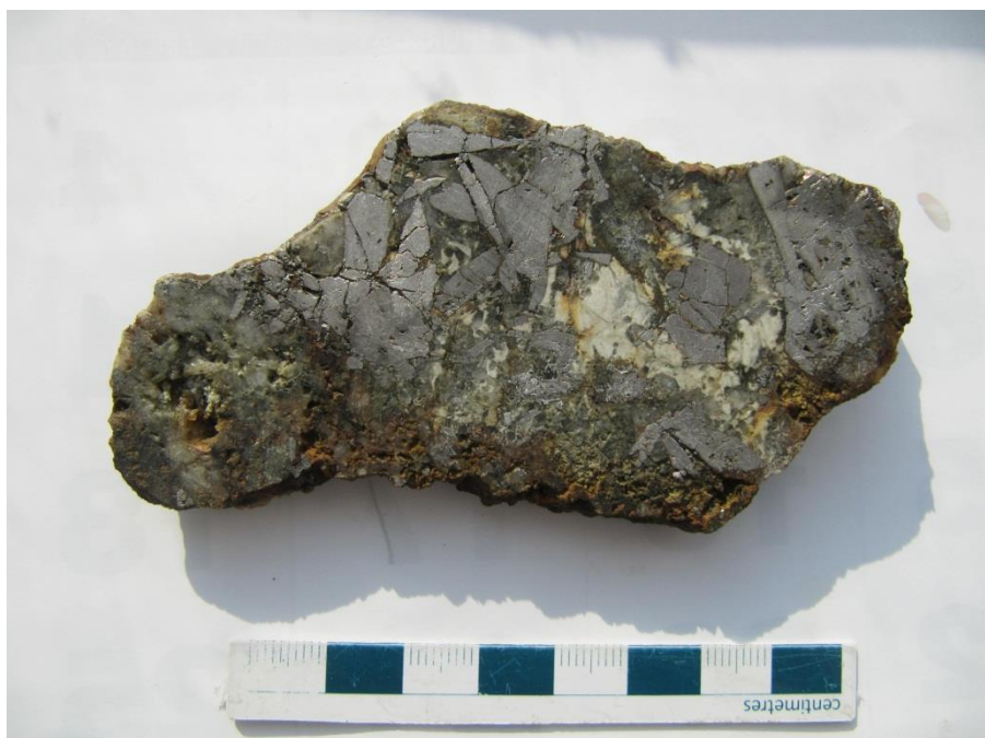
Рисунок 3.3.1 – Срез штуфа богатого арсенопиритом карбонат-кварцевого жильного гидротермалита. Штуфная проба №1.
