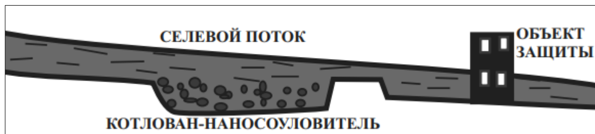
Рис. 3.6 Селезадерживающее сооружение – котлован-наносоуловитель
