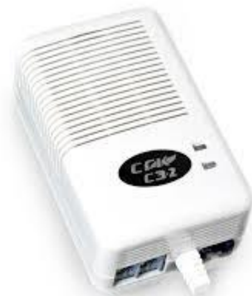
Рисунок 5.2 Внешний вид сигнализатора СЗ-2
