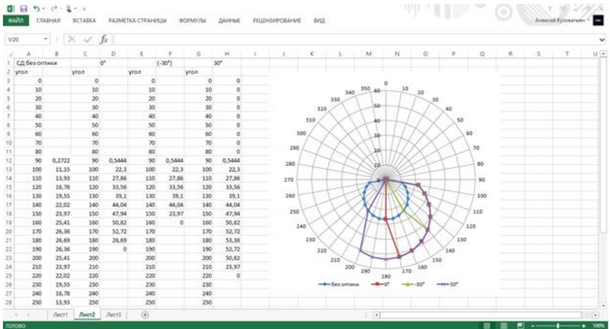
Рисунок 2.8 – Скриншот фрагмента программы для расчета КСС СД типа ARPL Star 1W EPS3 White
