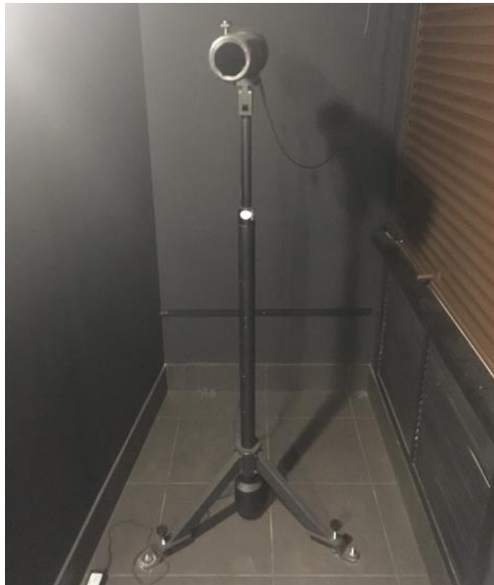
Рисунок 2.14 – Внешний вид фотометрической головки ID 1000
