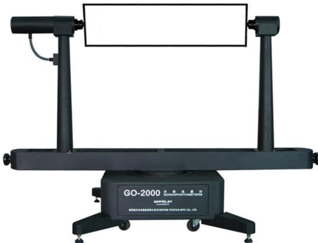
Рисунок 2.11 – Внешний вид гониофотометра GO2000
