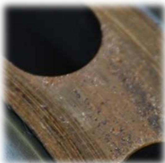
*в) задиры и износ на блоке цилиндров*
