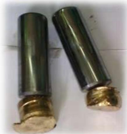
*д) катастрофический износ и поломка поршней, прижимной пластины*
