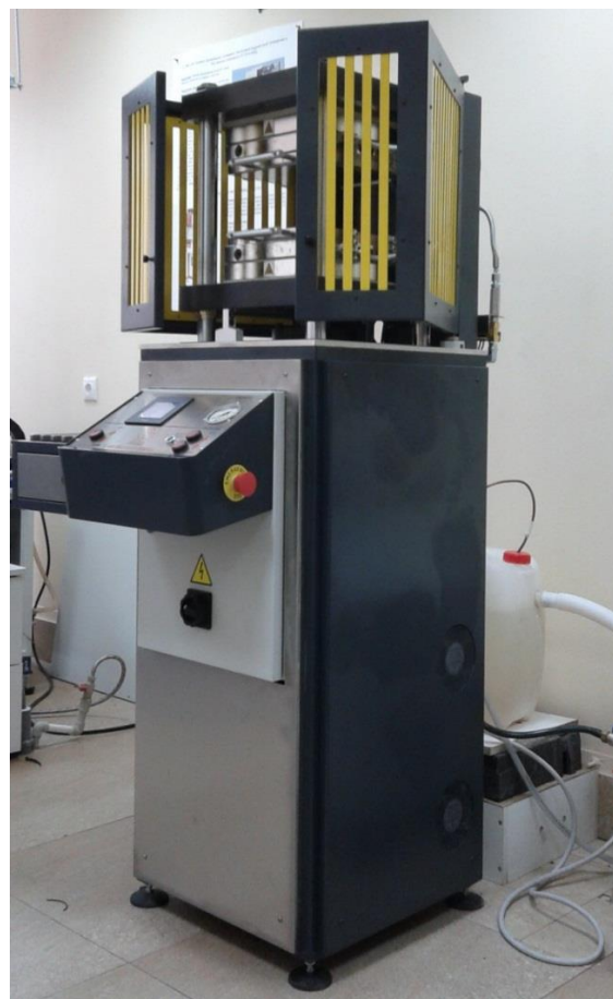
Рисунок 2.11 – Внешний вид лабораторного гидравлического пресса фирмы «Gibitre» (Италия), снабженного системами нагрева и охлаждения плит
