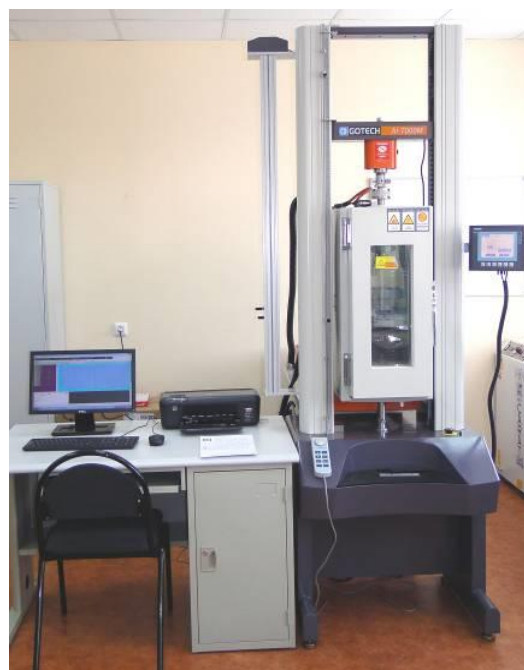
Рисунок 2.13 – Испытательная машина UAI-7000 М с термокамерой и компьютерным управлением
