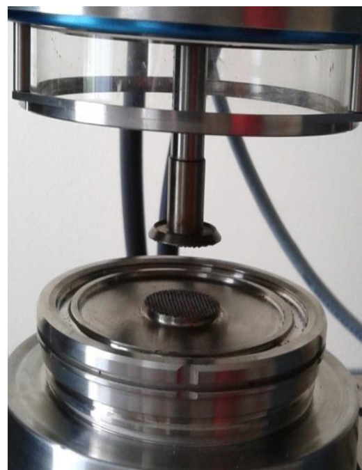
Рисунок 2.15 – Внешний вид измерительной системы реометра Haake MARSIII с рифлеными рабочими плоскостями
