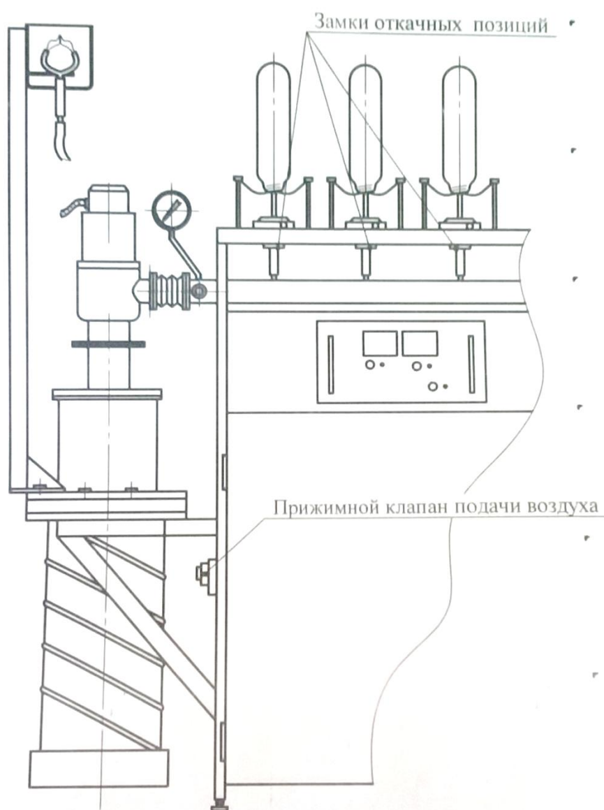
Рисунок 2.4 – Схема откачного поста ламп типа ДМГТ
