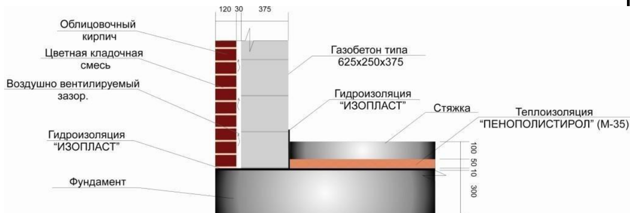
Рисунок 15 – Конструктивная схема стен
