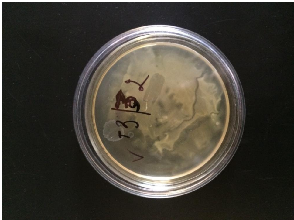
Рис. 4.5 – Рост колоний на МПА в чашке Петри. Смыв с поверхности образца №32 состава 3, находящегося в траншее
