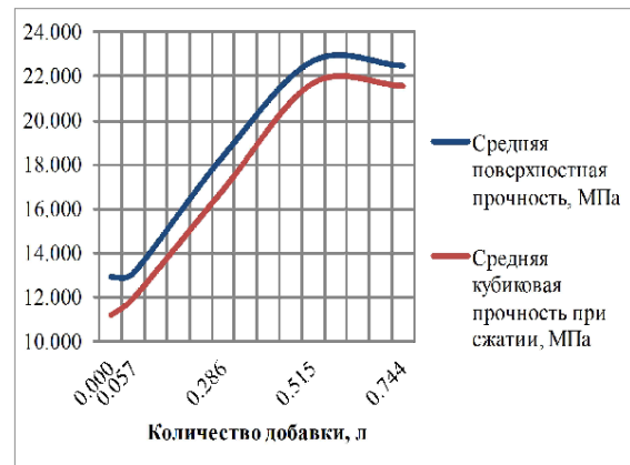
Зависимость изменения средней поверхностной прочности и средней кубиковой прочности бетона от количества пластификатора - "Эдванс Ульра"
