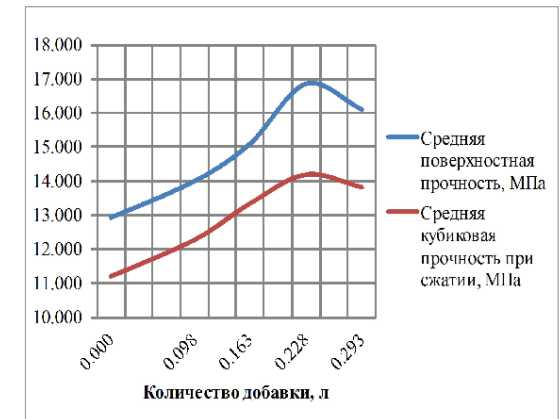
Зависимость изменения средней поверхностной прочности и средней кубиковой прочности бетона от количества комплексной добавки - "Суперпласт Стандарт"
