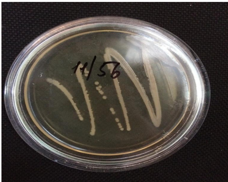
Рис. 4.21 – Рост колоний на МПА в чашке Петри. Смыв с поверхности образца №56 состава 11, находящегося в траншее
