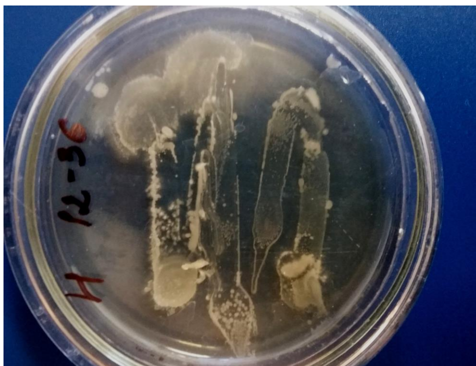
Рис. 4.79 – Рост колоний на МПА в чашке Петри. Смыв с поверхности образца № 36 состава 12, находящегося под навесом
