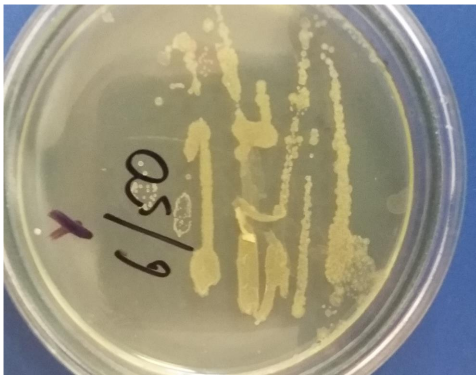
Рис. 4.41 – Рост колоний на МПА в чашке Петри. Смыв с поверхности образца № 50 состава 6, находящегося на площадке под открытым небом
