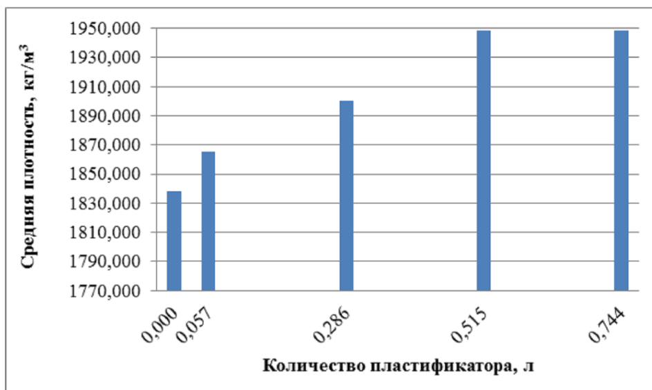
Зависимость изменения средней плотности бетона от количества пластификатора - "Эдванс Ультра"
