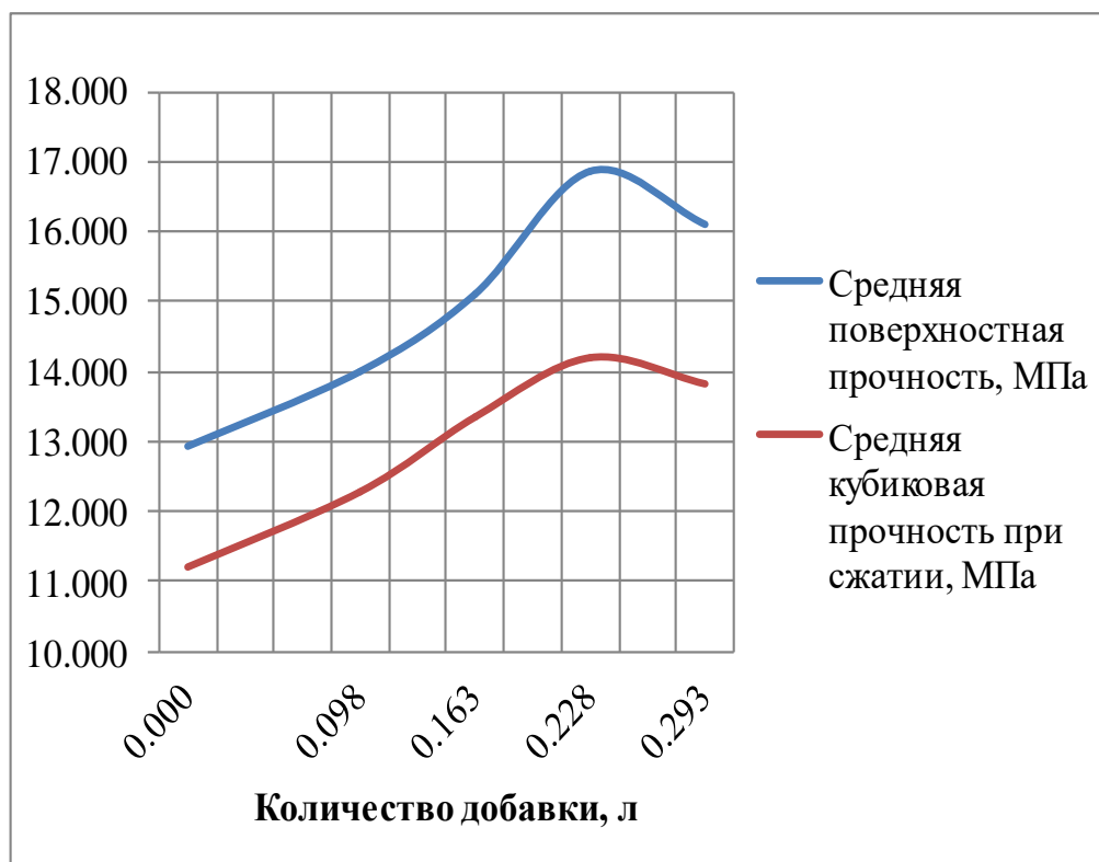
Рисунок 3.9 – Зависимость изменения средней поверхностной прочности и средней кубиковой прочности бетонов при сжатии от количества комплексной добавки «Суперпласт Стандарт»
