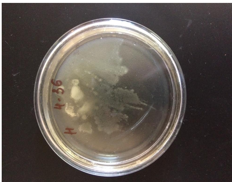
Рис. 4.63 – Рост колоний на МПА в чашке Петри. Смыв с поверхности образца № 36 состава 4, находящегося под навесом
