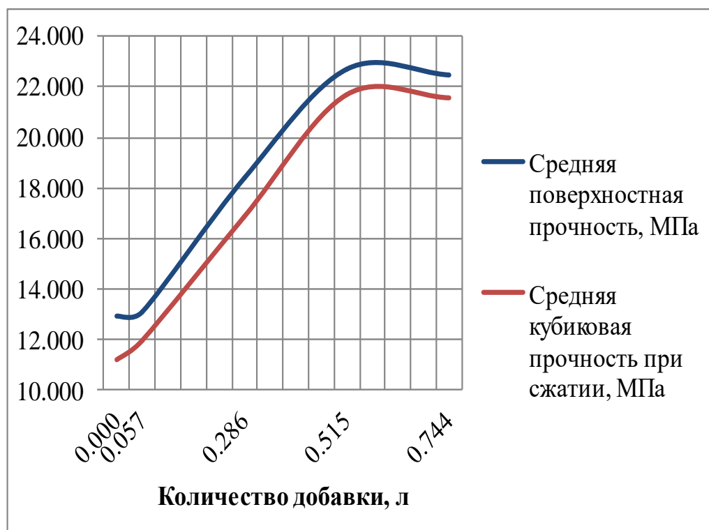
Рисунок 3.7 – Зависимость изменения средней поверхностной прочности и средней кубиковой прочности бетонов при сжатии от количества пластификатора «Эдванс Ультра»
