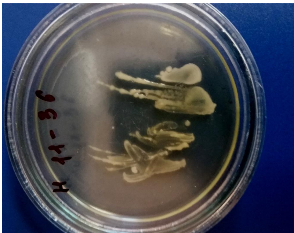
Рис. 4.77 – Рост колоний на МПА в чашке Петри. Смыв с поверхности образца № 36 состава 11, находящегося под навесом
