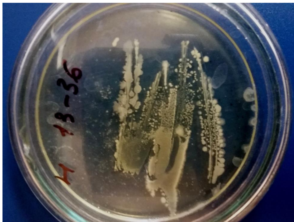
Рис. 4.81 – Рост колоний на МПА в чашке Петри. Смыв с поверхности образца № 36 состава 13, находящегося под навесом
