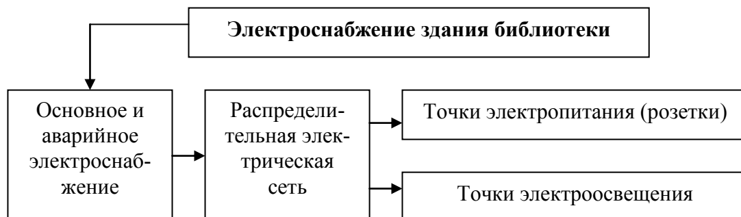
Рисунок 3 – Структурно-функциональная схема электроснабжения
