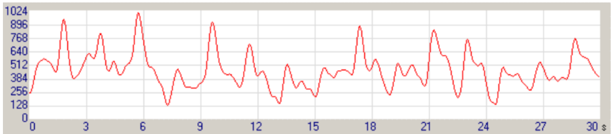
Рисунок 3.7 – Осциллограмма сигналов говорящего человека
