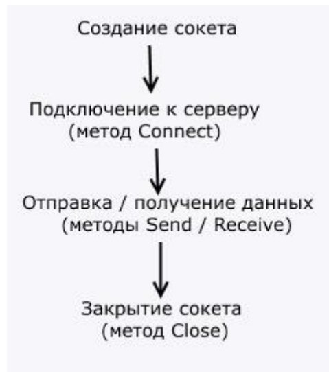
Рисунок 2.3 – Работа клиента на основе TCP протокола
