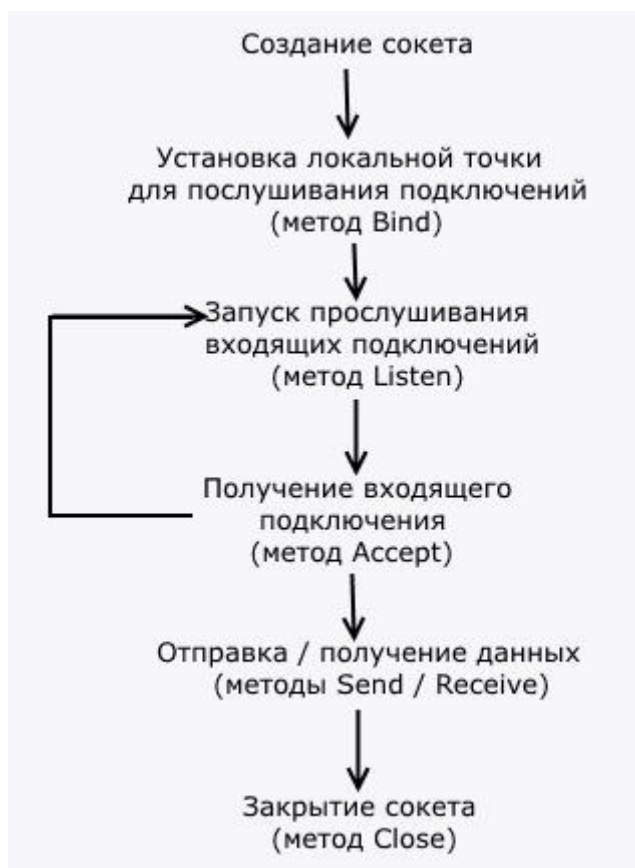
Рисунок 2.2 – Схема работы сервера на основе TCP протокола
