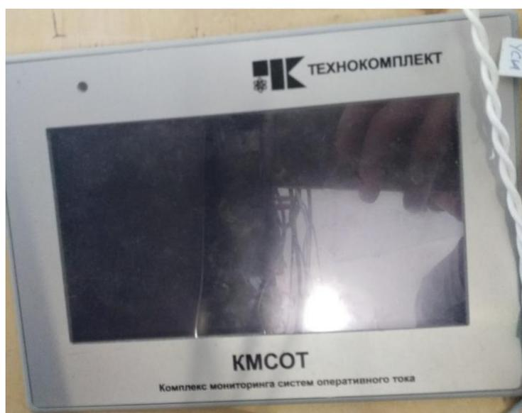
Рисунок 32 – Операторная панель KMCOT
