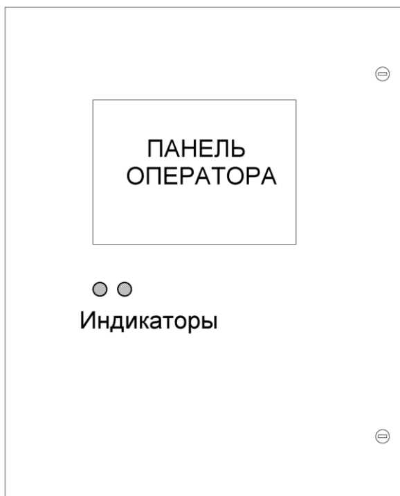
Рисунок 16 – Лицевая панель шкафа управления
