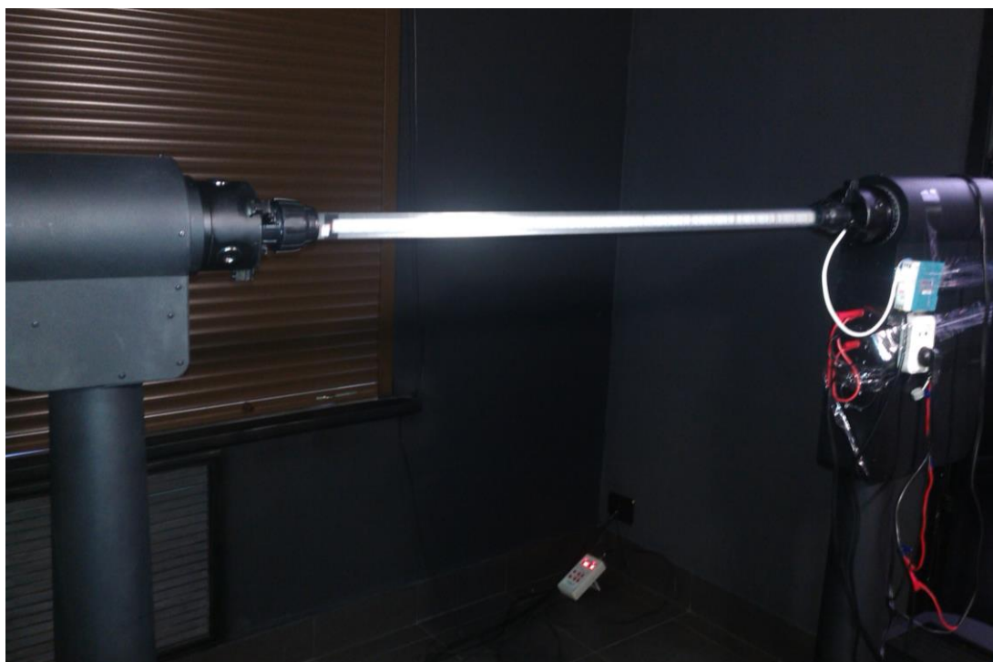
Рисунок 3.32 – Гониофотометр GO-2000А с исследуемым светильником
