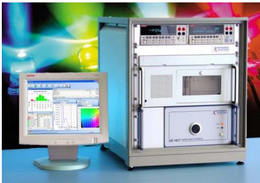
Рисунок 6 – Внешний вид аппаратно-программного комплекса LED Tester
