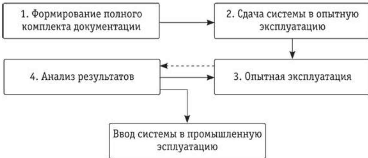
Рисунок 2.23 — Этапы ввода системы в промышленную эксплуатацию
