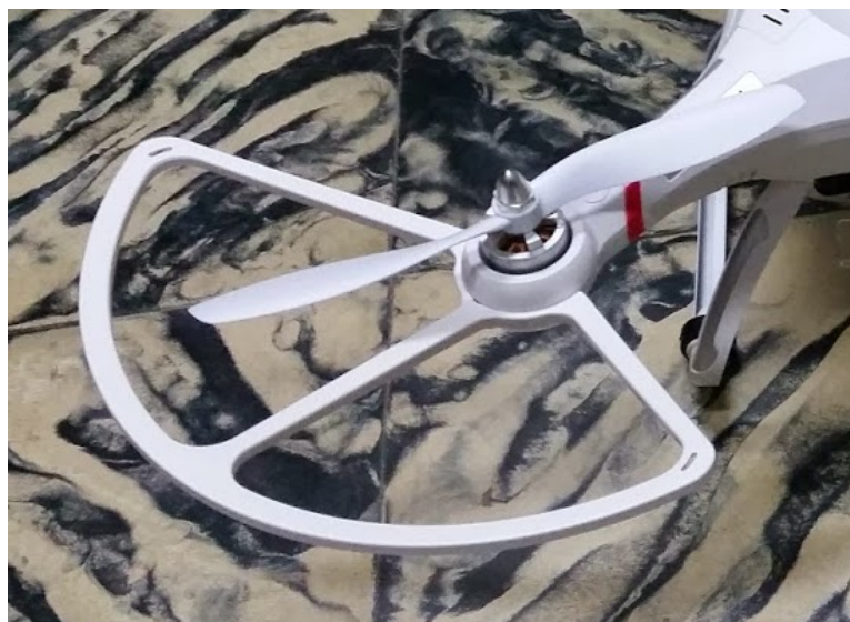
Рисунок 2.1 – Защитный элемент винта квадрокоптера Quantum Nova
