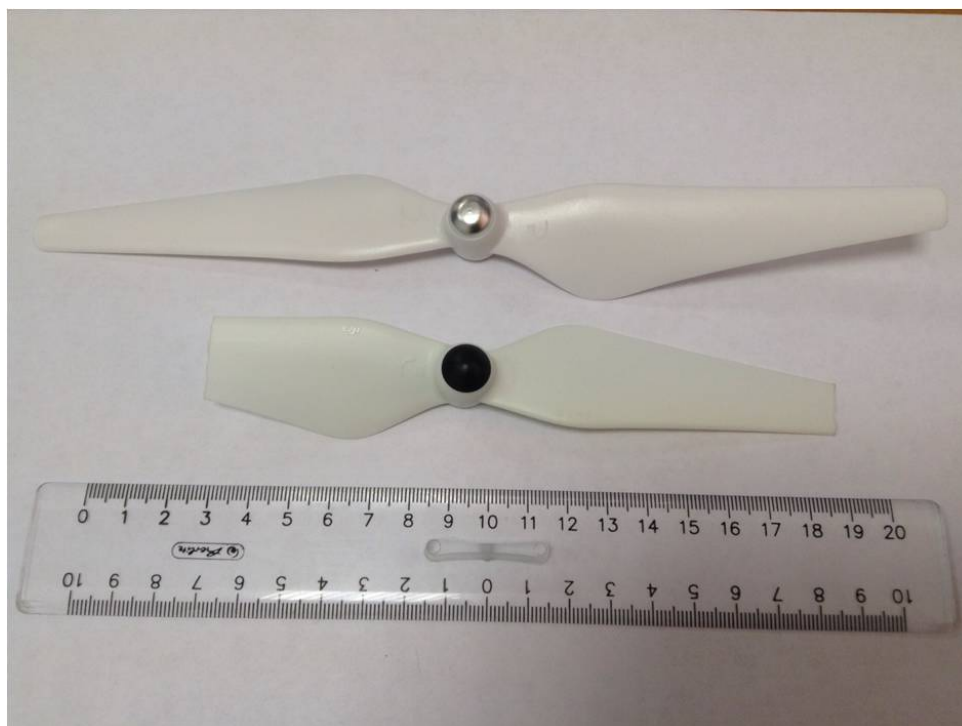
Рисунок 6.3 – Поврежденный (снизу) и исправный винт
