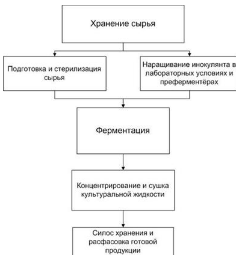
Рис. 1.4. Схема технологического процесса производства L-лизин сульфата
