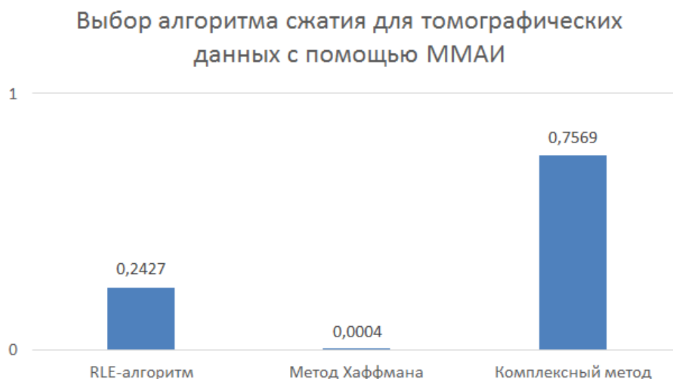
Рисунок 2.10 – Результаты выбора ММАИ эффективного алгоритма для сжатия томографических данных
