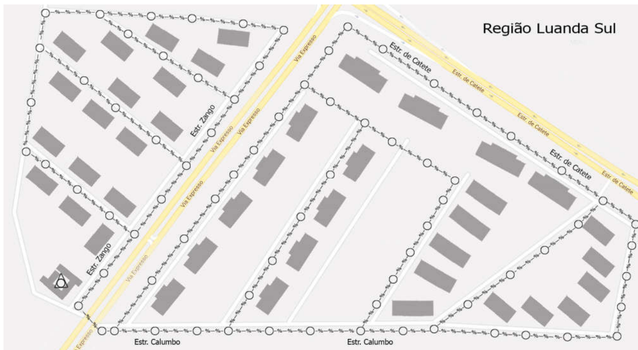
Рисунок 1.2 – Схема телефонно-кабельной канализации района Луанда Сул
