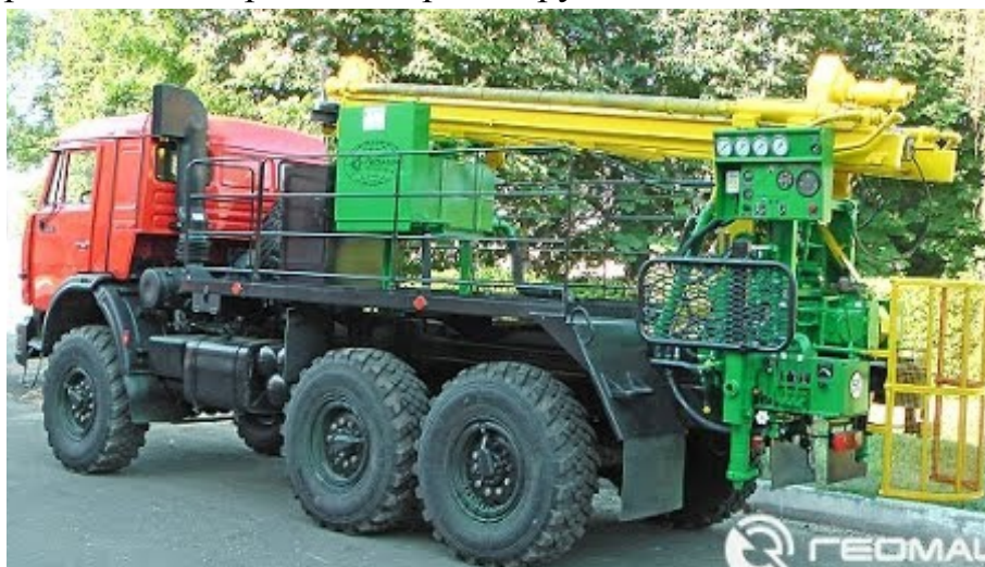
Рисунок 3.1 – Буровая установка ПБУ-2
