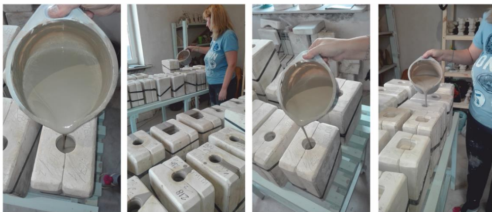
Рис. 1.1 Заливка шликера в формы
