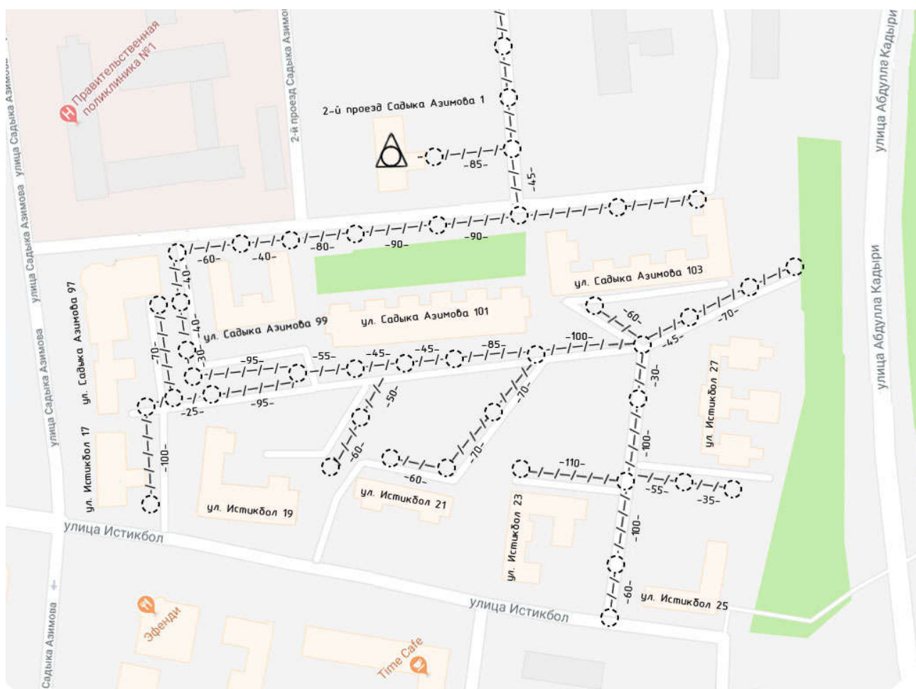
Рисунок 1.3 – Схема проектируемой телефонно-кабельной канализации для жилого комплекса «Яшнаобад»
