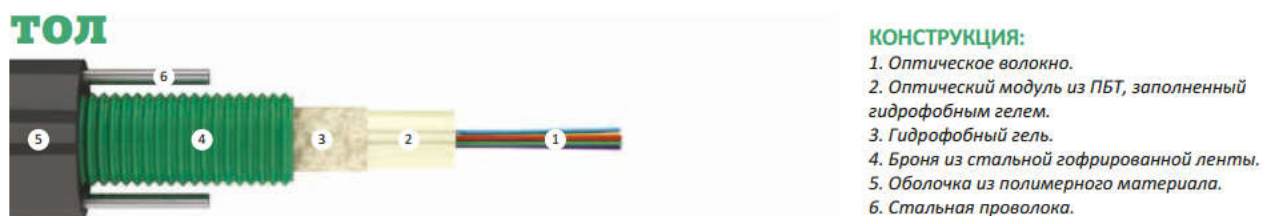
Рисунок 3.3– Конструкция кабеля суперлегкого оптического кабеля [26]
