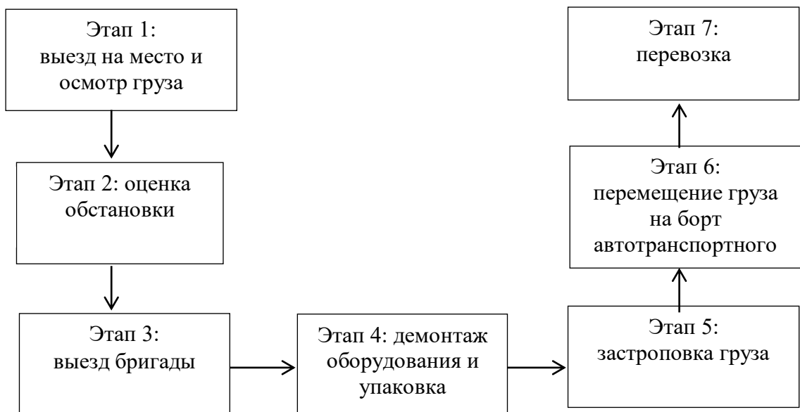
Рис. 3.2. Этапы проведения такелажных работ
