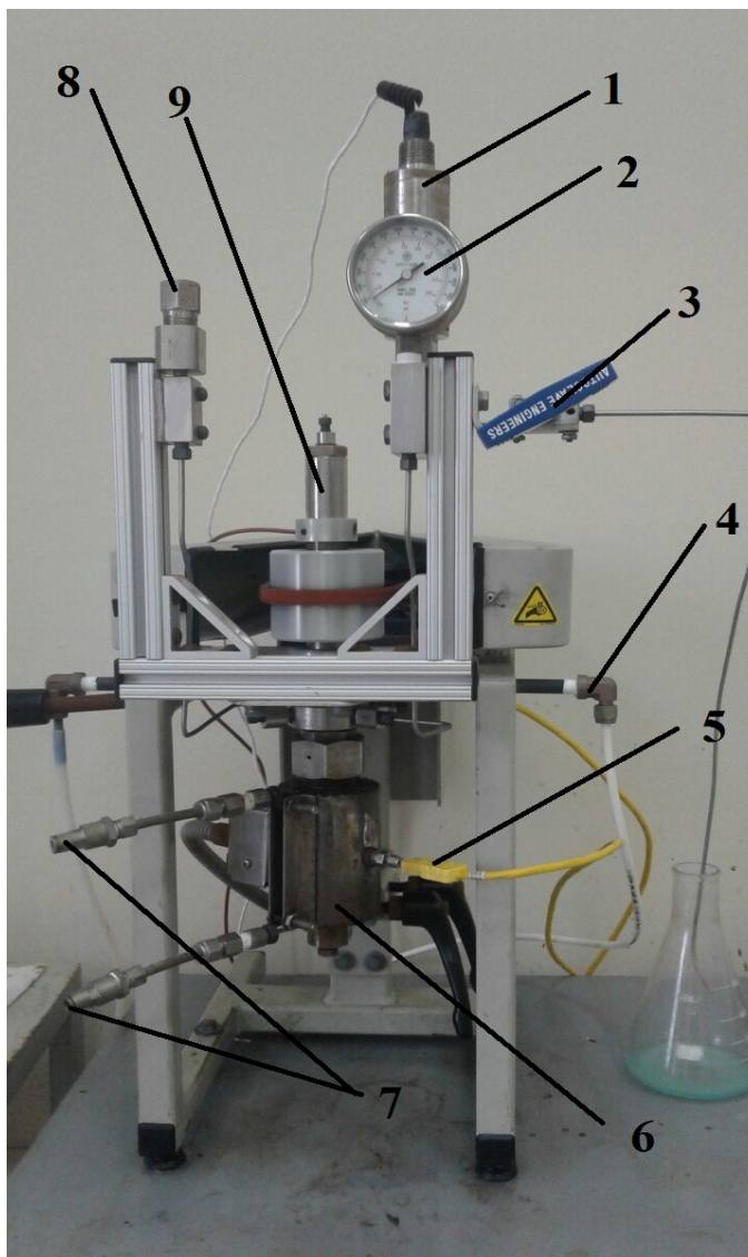
Рис. 2.1. Схема реактора (автоклава) PARKER, autoclave Engineers (USA). 1) датчик давления; 2) манометр; 3) игольчатый кран для сброса избыточного давления; 4) подвод охлаждающей жидкости к магнитному приводу мешалки; 5) датчик температуры (термопара К-типа); 6) реакционный сосуд в нагревательном кожухе; 7) патрубки для подачи охлаждающей жидкости реактора; 8) прорывная мембрана для аварийного сброса давления; 9) привод мешалки.
