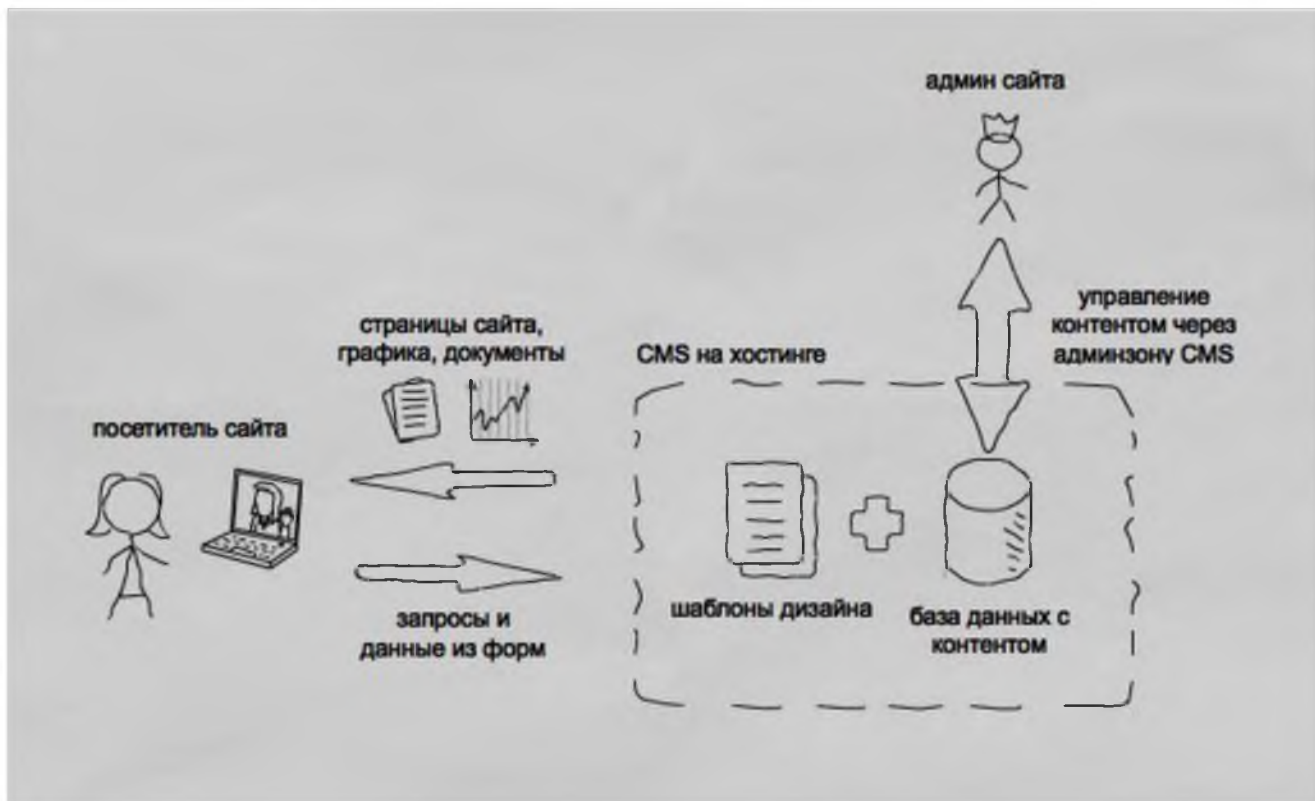
Рис. 2.1 Принцип работы с системой управления содержимым
