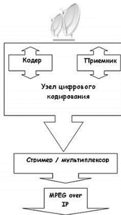
Рисунок 2.1 - Упрощённая схема организации передачи видео сигнала со спутника в сеть IPTV (SAT-приёмник)
