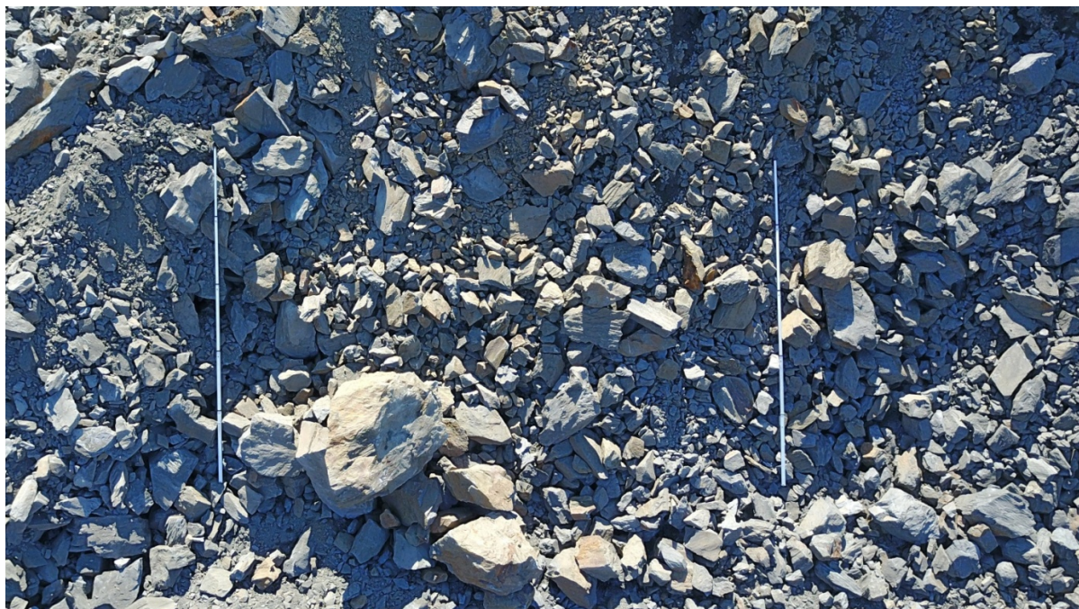
Рисунок 3.4 — Фотоснимки поверхности развала взорванной горной массы
