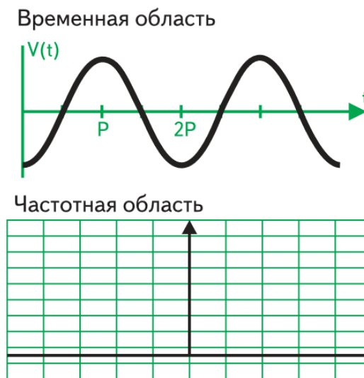
Рисунок 1.14 – Идеальный сигнал во временной и частотной области
