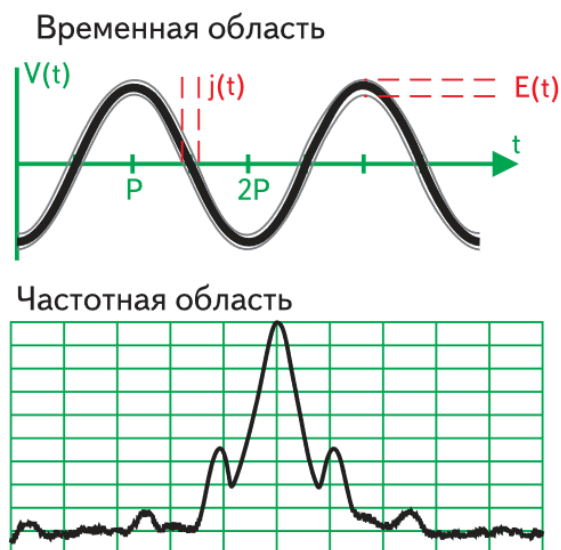
Рисунок 1.15 – Реальный сигнал во временной и частотной области
