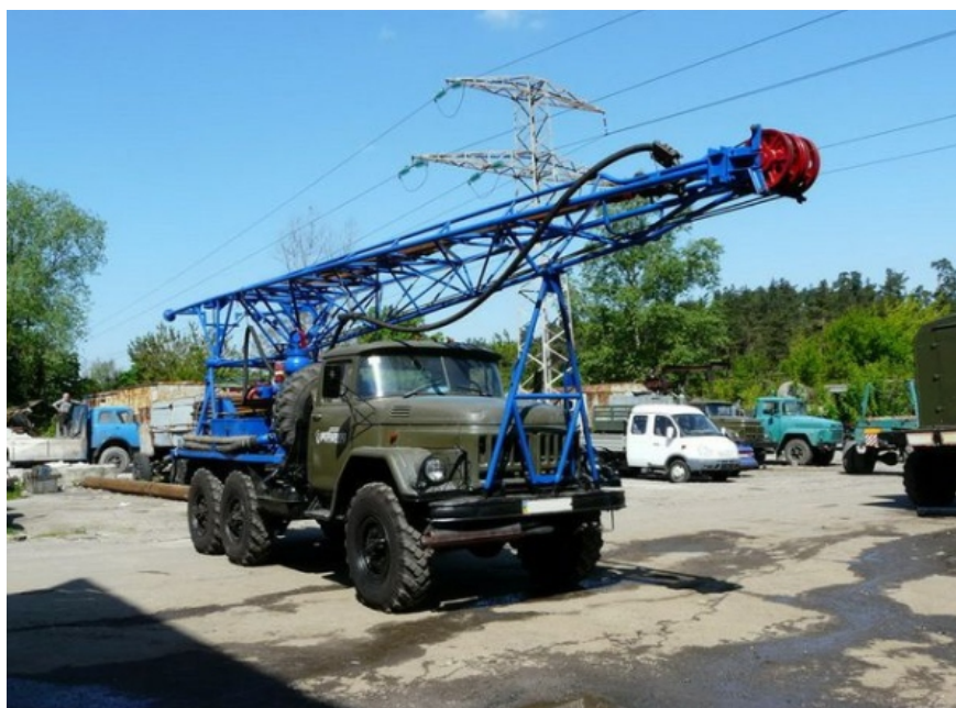
Рисунок 3.3 – Буровая установка УРБ-2.5А
