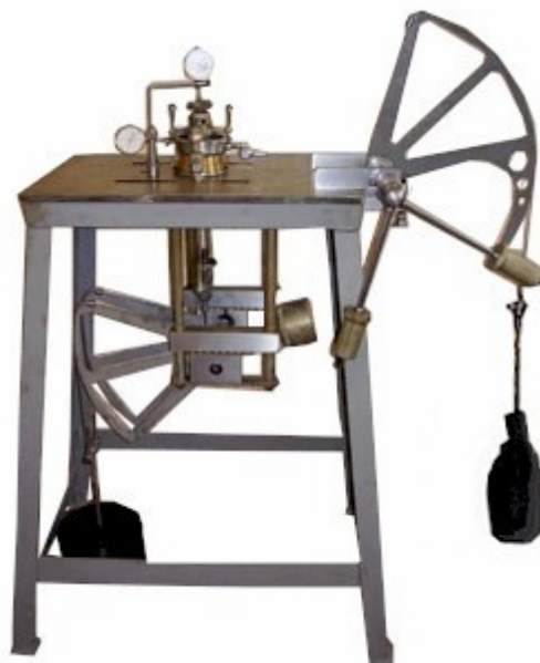
Рисунок 2.6 – Прибор для определения деформационных и прочностных свойств грунтов ПСГ-3М
