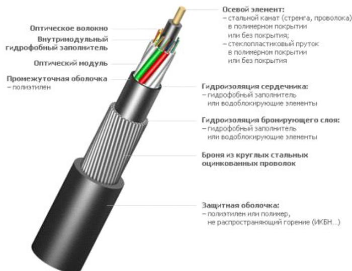
**Рисунок 6.1 - Элементы волоконно-оптического кабеля марки ИКБ**
