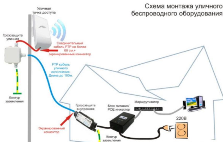
**Рисунок 2.11 – Схема оборудования на стороне абонента частного дома**
