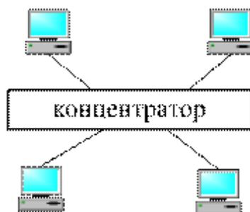
Рисунок 2.2 – «Пассивная звезднообразная» топология
