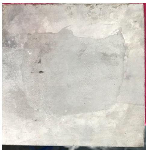
а) Пластина из нержавеющей стали, загрязненная животным жиром
