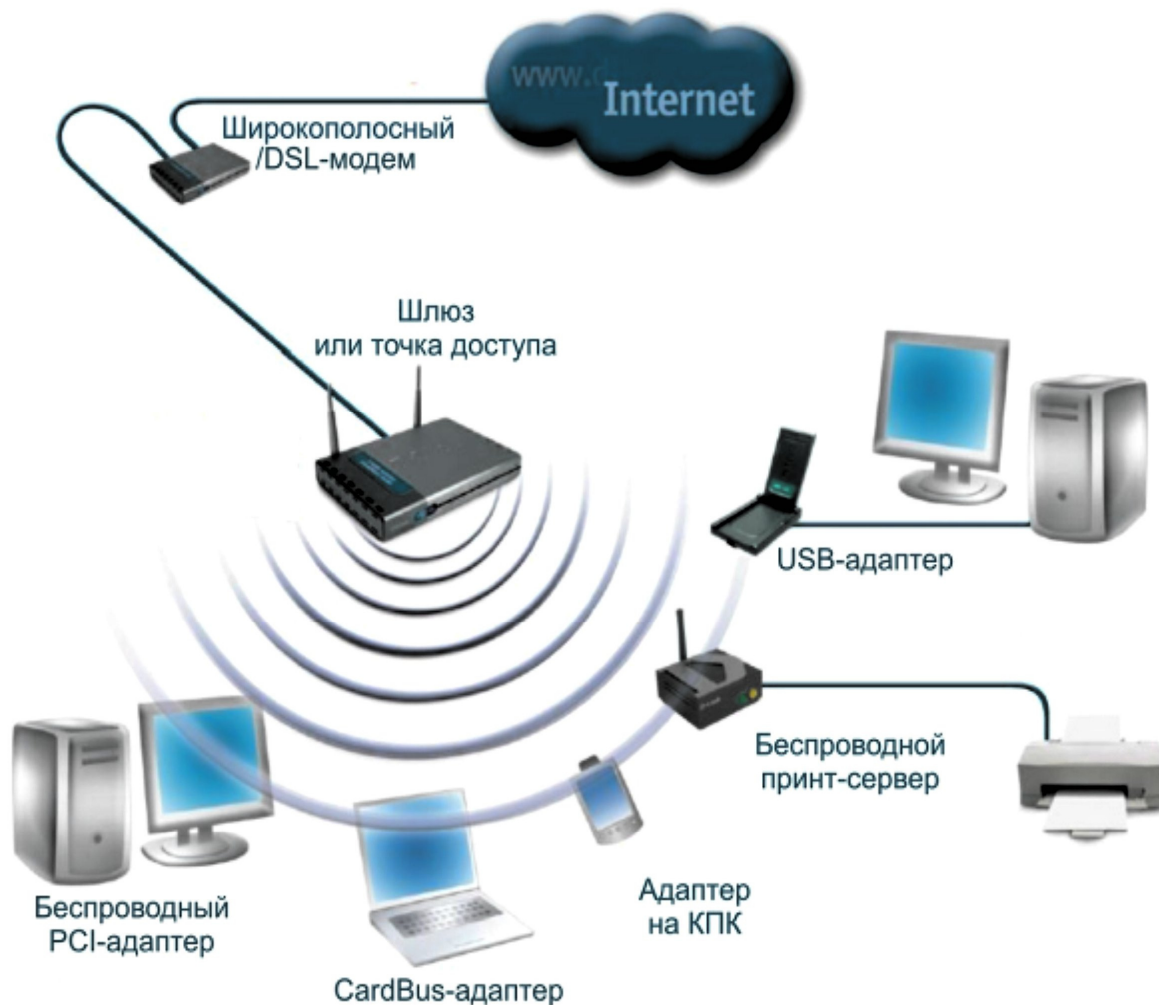
Рисунок 2.4 – Построение сети на базе Wi-Fi.
