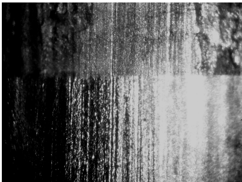
Фото № 17: Совмещение исследуемого и экспериментального следов.
