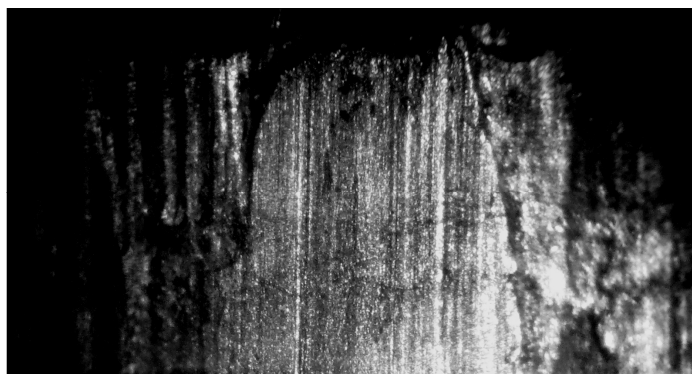
Фото № 15: След канала ствола на исследуемой пуле (запечатлен при 10-ти кратном увеличении).
