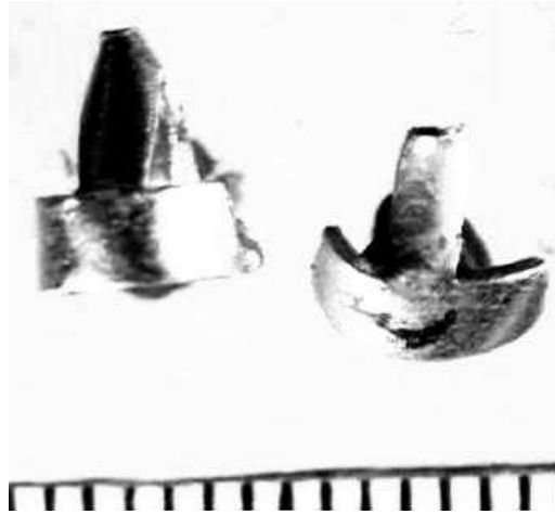
Рис. 1. Два фрагмента от оболочки пули, выстреленной из самодельного огнестрельного оружия, имеющего дефекты канала ствола
