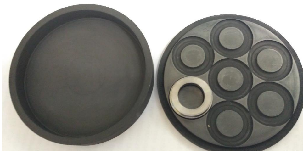
Рис. 16 Многоразовый графитовый тигель с крышкой и отполированной поверхностью под оправки
