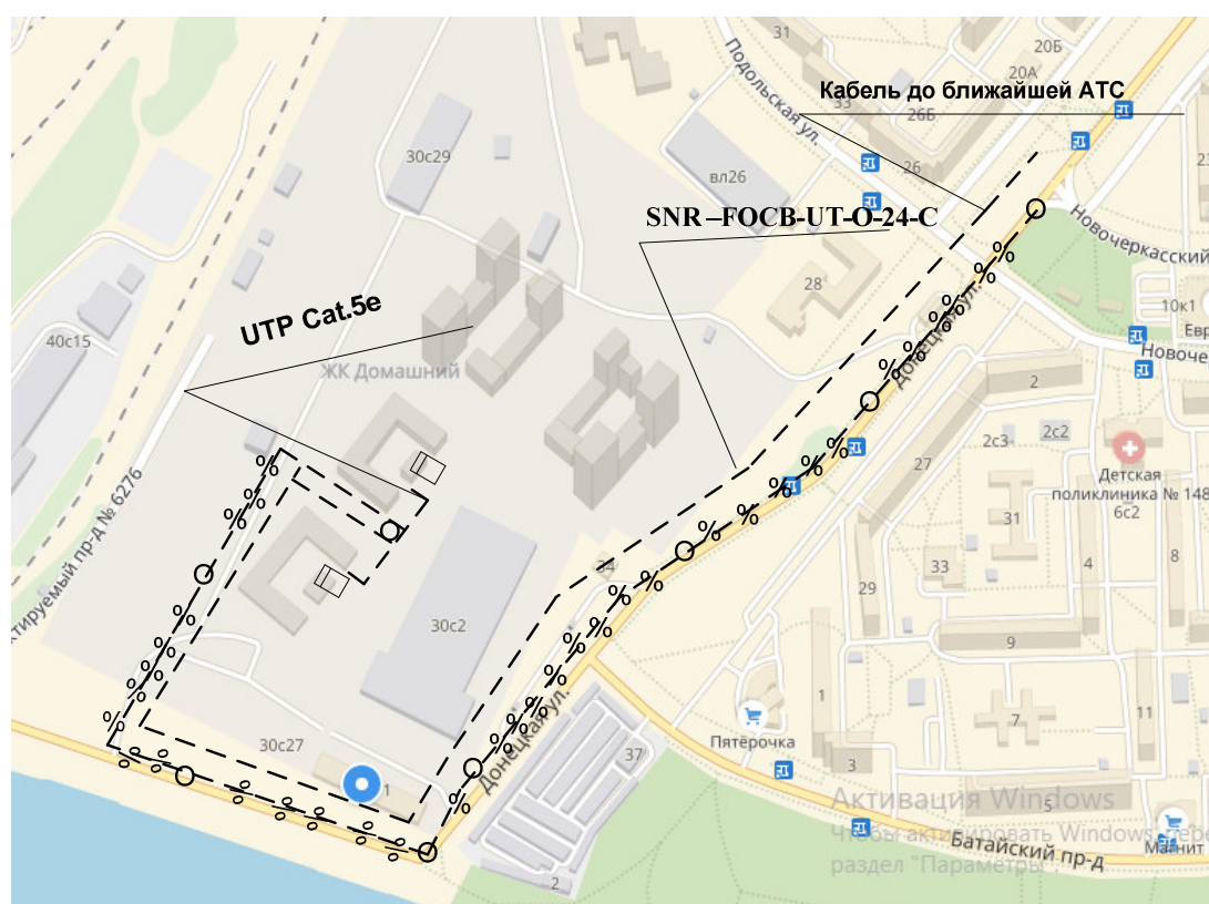
Рисунок 4.5-Ситуационная схема трассы прокладки кабеля
