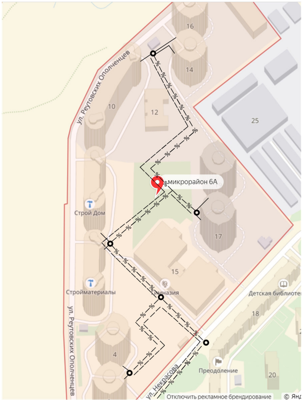
Рисунок 4.5 — Прокладка кабеля к зданиям микрорайона “6 А”
