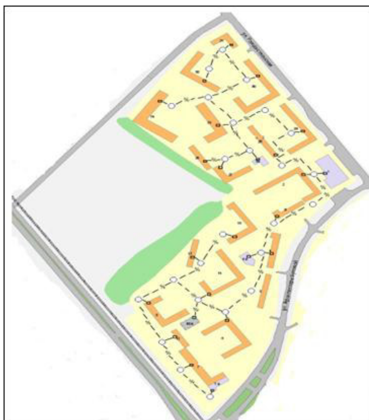
Рисунок 7.1 Схема кабельной канализации района Кировский
