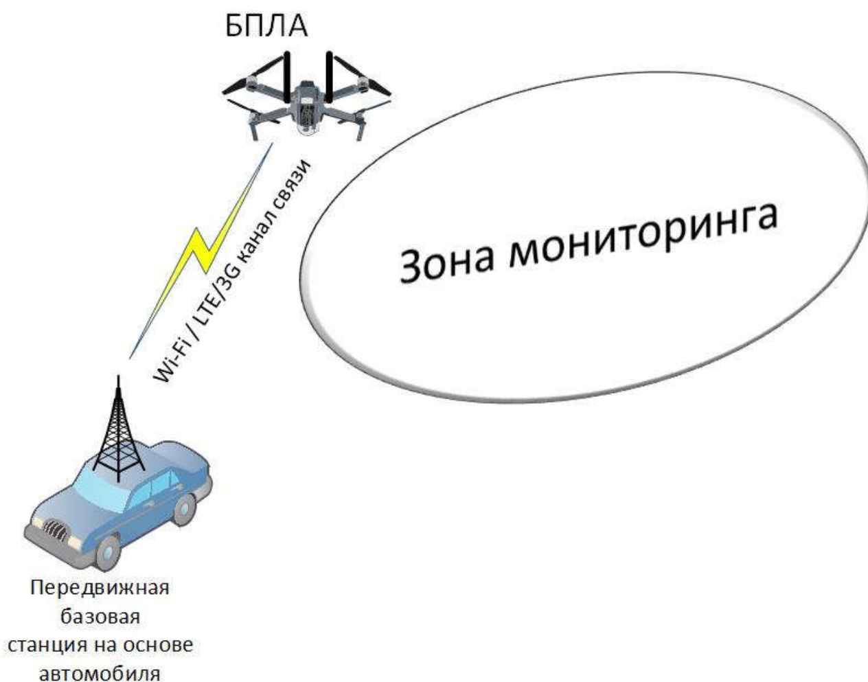
Рисунок 3.2 – Схема организации беспроводной сети с помощью передвижной базовой станции
