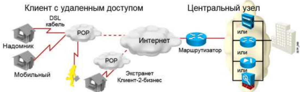
Рисунок 2.4 – VPN удаленного доступа как развитие сетей коммутируемого доступа и сетей с интеграцией обслуживания
