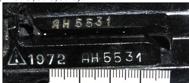
Иллюстрация №5. Маркировочные обозначения на ствольной коробке и затворной раме автомата.
