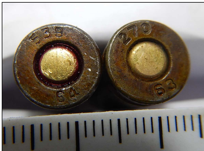
Иллюстрация №10. Маркировочные обозначения на донцах гильз представленных патронов.
