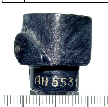
Иллюстрация №6. Маркировочное обозначение на затворе.
