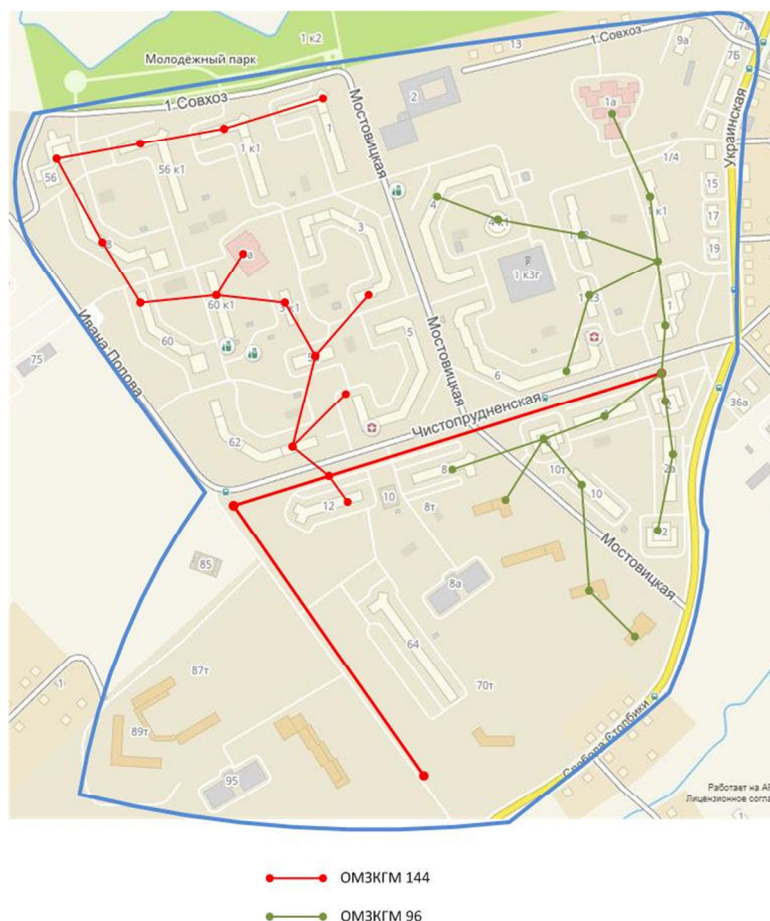
Рисунок 5.2 - Схема организации связи на магистральном участке микрорайона Чистые пруды г. Кирова
