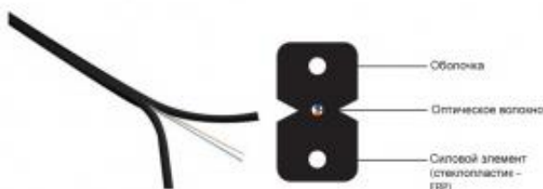
Рисунок 4.8 – Оптический кабель Alpha Mile Flex FTTx
