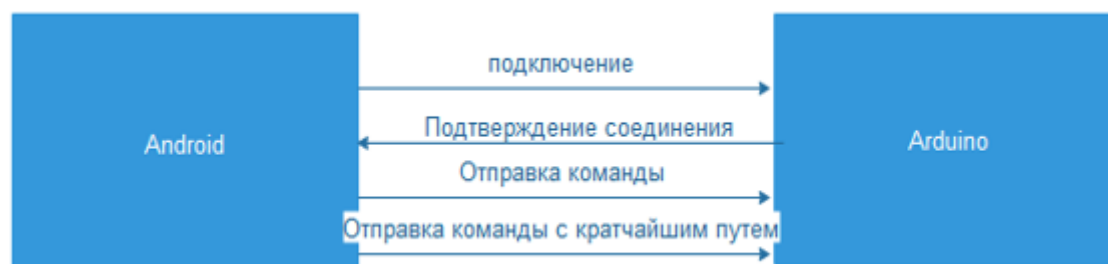
Рис.2.4. Схема передачи данных между устройствами при режиме перемещения
