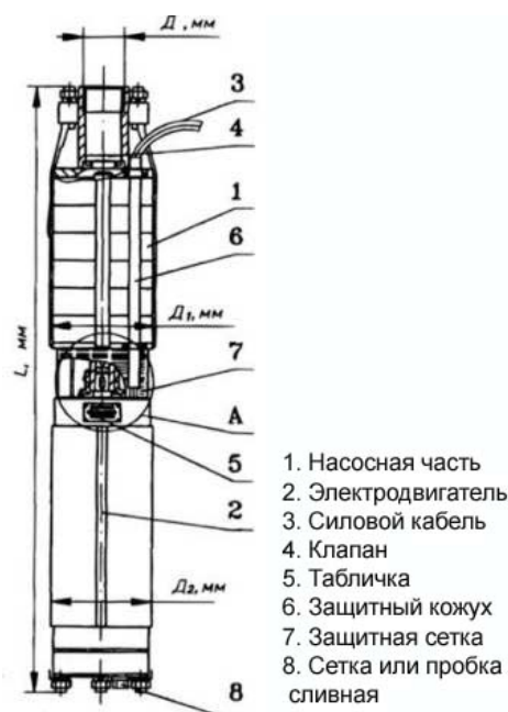
Рисунок 3.2— Насос ЭЦВ в разрезе
