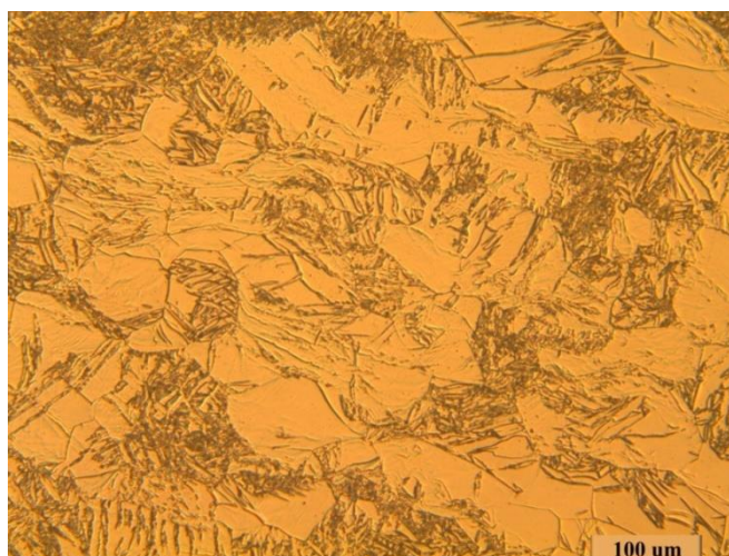
Рис. 3.5 Микроструктура образца №6 (прокатка при комнатной температуре)
