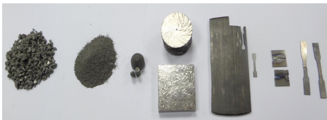
Рис. 2.1 Этапы получения сверхчистого титана
