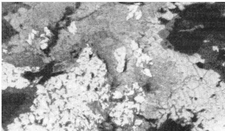
Рис. 15. Замещение пентландита (белое) джерфишеритом (серое). Полированный шлиф Р-358, увел.165. Трубка «Удачная-Восточная». Тёмно-серое - гранат, чёрное – слюдистый минерал
