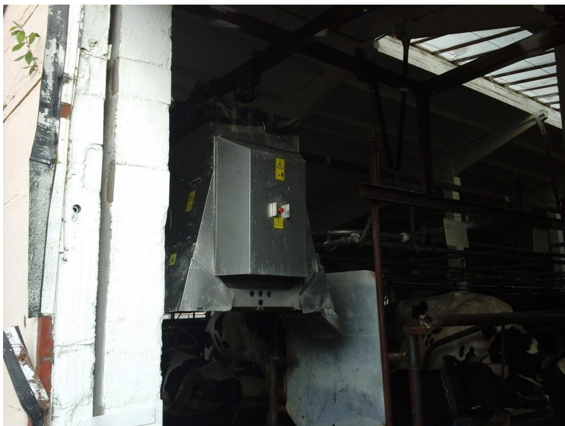
Рис. 36. Станция для раздачи комбикорма, лактирующим коровам, на DelPro (привязь, 2 двор)
