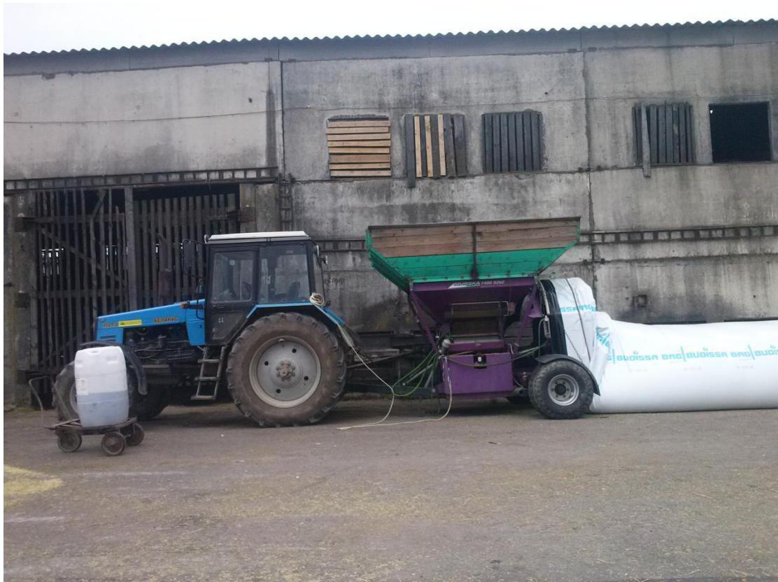
Рис. 44. Консервирование зерна пшеницы в рукавах.
