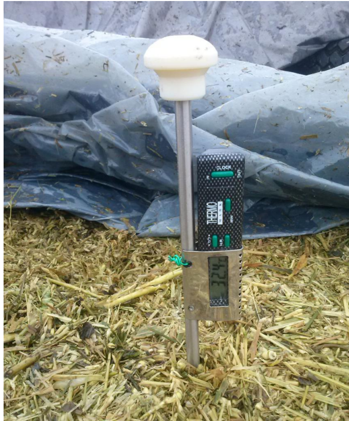
Рис. 40. Измерение температуры зеленой массы при закладке на зерносегаж.
