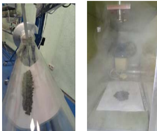
Рисунок 5 - Лабораторные исследования по изучению влияния фракционного состава на интенсивность влагообмена
