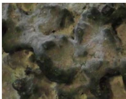
Рисунок 15 – Образование твердой поверхности на очаге возгорания угля
