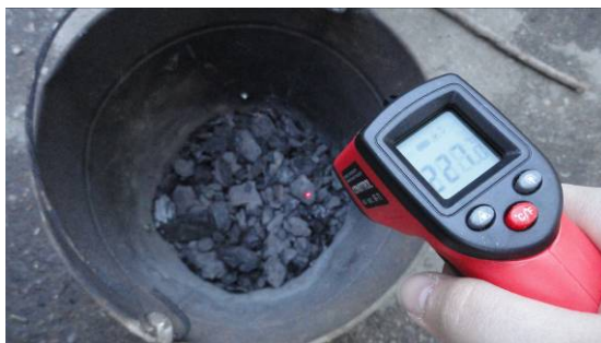
Рисунок 14 – Активированные угли с температурой 227^{\circ}\text{C}
