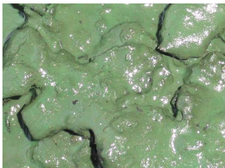
Рисунок 13 – Раствор для борьбы с эндогенными пожарами в Коркинском угольном разрезе
